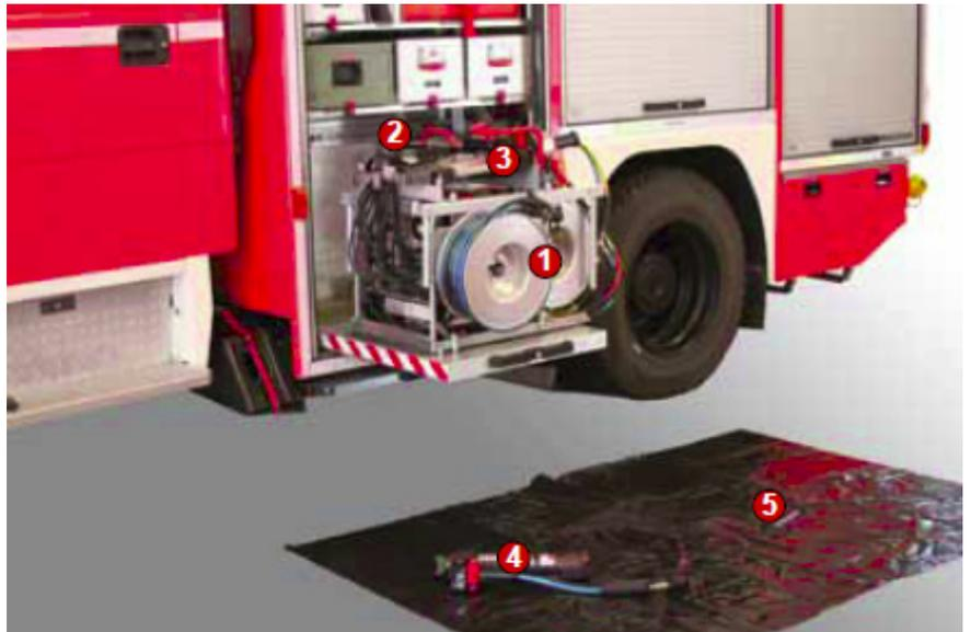
Der Trupp soll den hydraulischen Rettungssatz für den Einsatz vorbereiten, die Hydraulikschläuche kuppeln sowie mindestens vier der genannten Punkte nennen:
